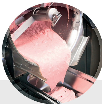
Při úplném sklopení kotle je vzdálenost od podlahy více než 600 mm.
